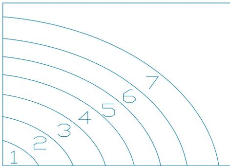
图 5.1.2-2 推移式连续浇筑施工
